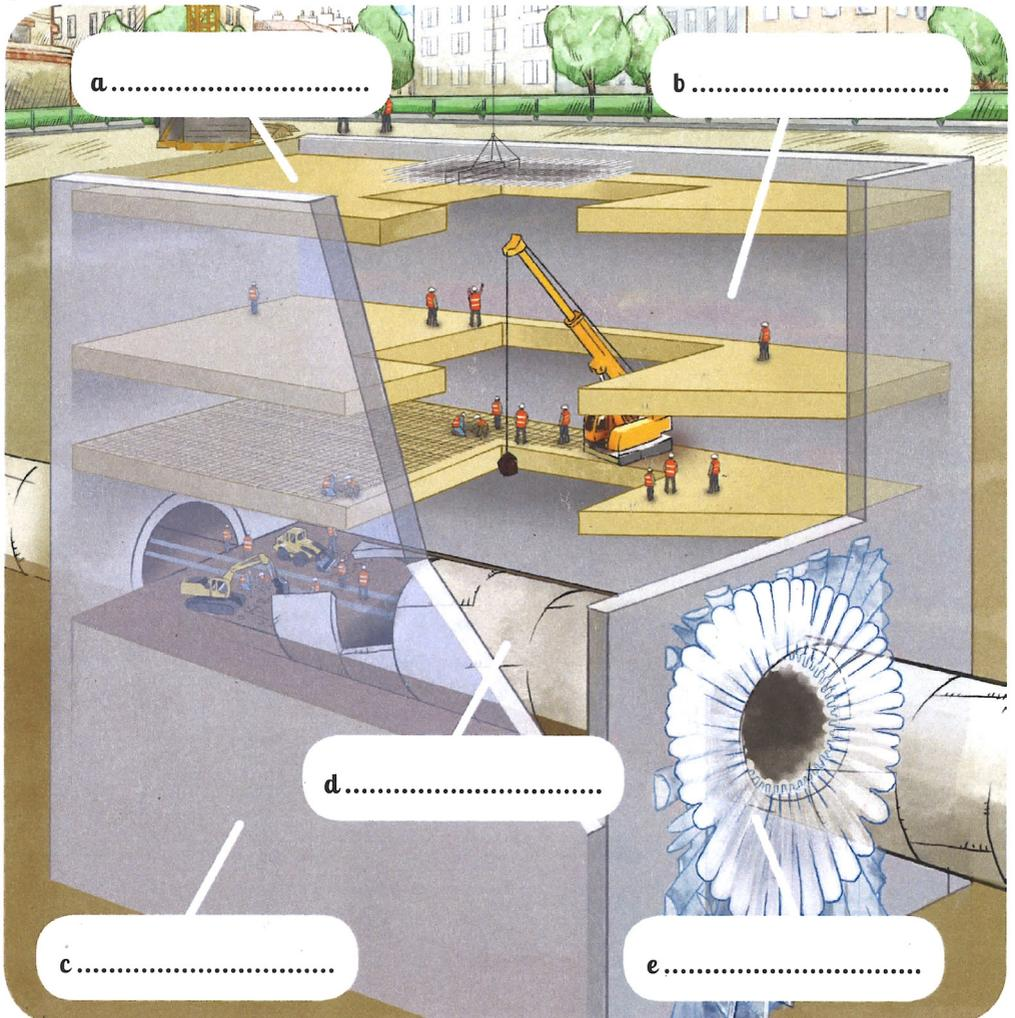
Solutions : a - Dalle de couverture / b - Etage de la future station / c - Paroi moulée / d - Tunnel / e - Terrain congelé
