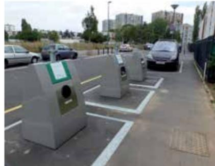
Borne de tri sélectif des déchets, avec dispositif d'aspiration pneumatique.
