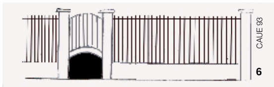
La forme de la clôture est établie sur le modèle ancien (mur bahut + grille).
